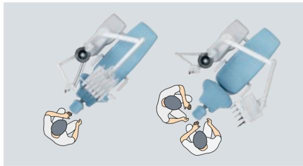
Assistenzelement besitzen einen großen Bewegungsradius und lassen sich jederzeit passend positionieren. In der Schwingversion sorgt die maximale Auszugslänge der Instrumentenschläuche von 90 cm und die geringe Tischhöhe von 45 cm für zusätzlichen Raum.
