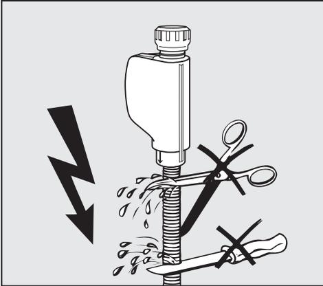
⚠ Der Zulaufschlauch darf **nicht** gekürzt oder beschädigt werden (siehe Abb.!).
