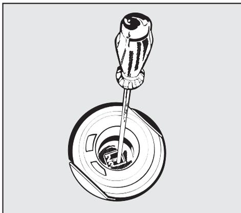
Der Dosierwähler in der Einfüllöffnung ist von 1 bis 6 einstellbar, das entspricht 1 - 6 ml. Serienmäßig ist er auf 3 ml eingestellt.
